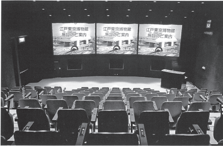
▲150インチ・3面スクリーンを設備した映像ホール全景。写真右上はビデオプロジェクターおよび映像・音響機器架、右下は操作卓。
